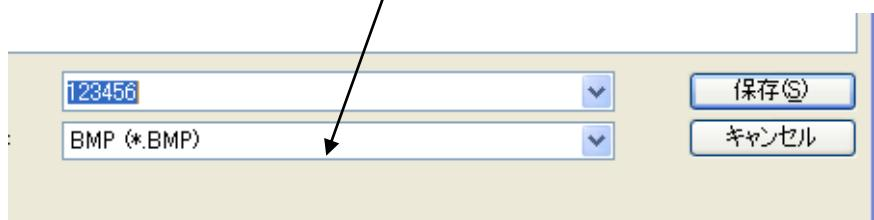
切断データと彫刻データをファイル名同じにすると切断と彫刻が同時にできます。
