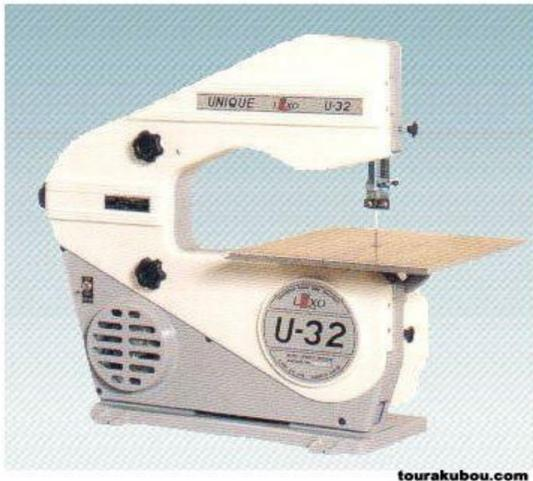
適用材料: 鉄鋼、合金、プラスチック、ゴム、布等鋸刃を変えることによりあらゆる材料を切断できる。
