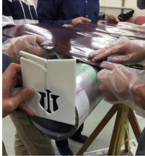
図4 3Dプリンターを用いて製作した治具
