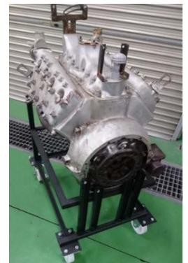
用部材を 3 mm厚(SS400)の等辺アングル鋼とチャンネル鋼のみ(車輪ベースは 3 mm厚鉄板)による溶接とし、シンプルで無駄のない構造によって、軽量・安価ながらも実用耐荷重を高くすることができました。
