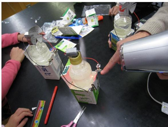
写真 1 9 南大野小学校でのテーマは風力発電ドライヤーの風でLEDが点灯
