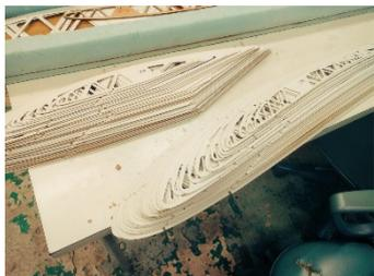
図 3 レーザー加工機で製作した翼の治具
