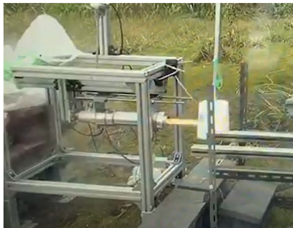
図1 J-2i 燃焼時（架台に取り付けられている円筒部がエンジン）
