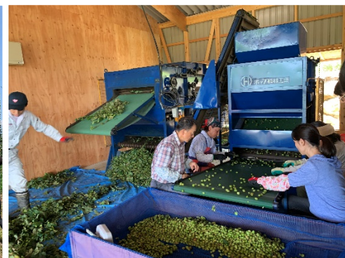
図8 摘果機(写真奥)と選別機(手前)
