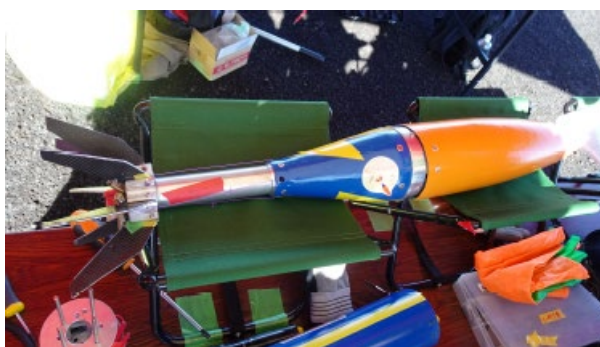
図 3 C-43J 二段目実機（一段目先端に折り畳み式機構により収納されている）
