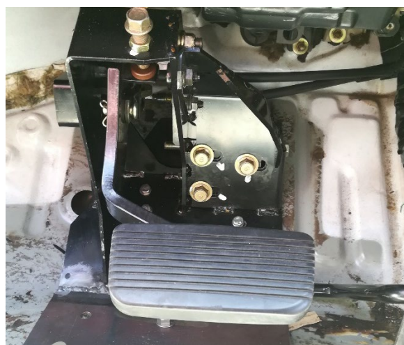
図 2. 設置した補助ブレーキ
