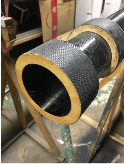
図2 主翼桁接合部の様子
