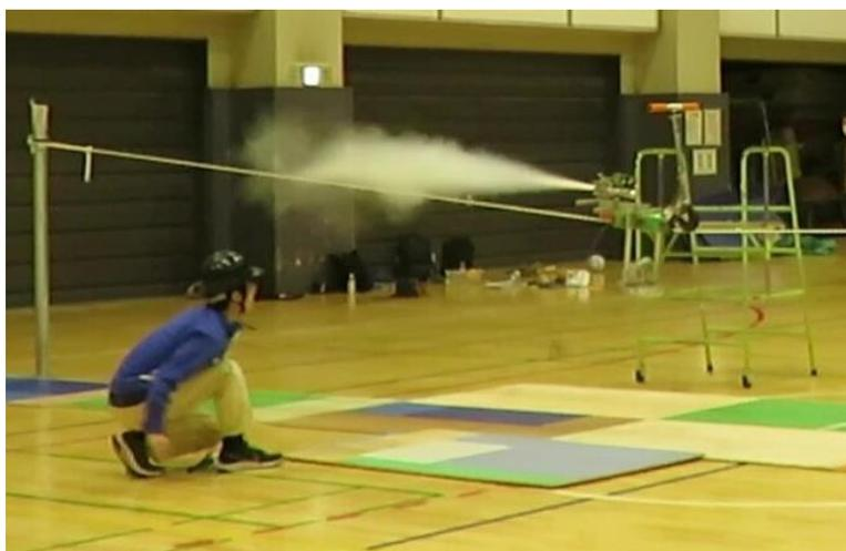
高圧CO<sub>2</sub>ガスによるジェット噴射によるスタートダッシュ
